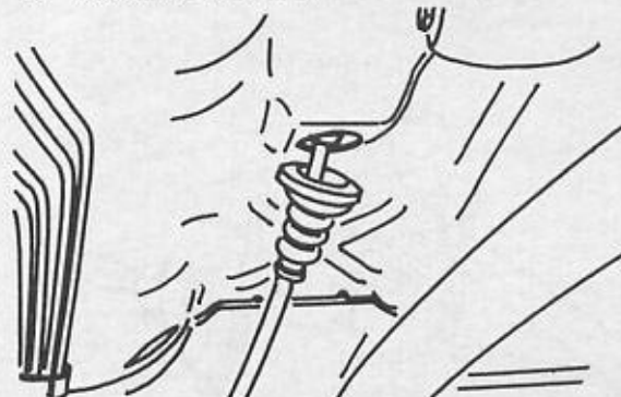
Rys. 5.61. WYMONTOWANIE LINKI STEROWANIA A – zamocowanie linki do ręcznej dźwigni sterowania B – mocowanie pancerza linki do obudowy
