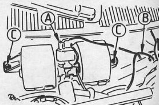
Rys. 9.16. WYMONTOWANIE DMUCHAWY A – złącze wtykowe B – przewód masowy C – śruby mocujące dmuchawę
